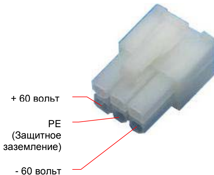
Рис. 2.6. Внешний вид разъема питания MF-6F и назначение контактов
