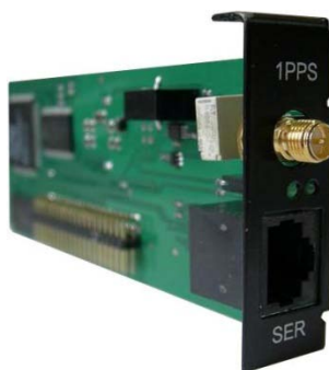
Рис. 2.19. Внешний вид модуля «IRIG»
