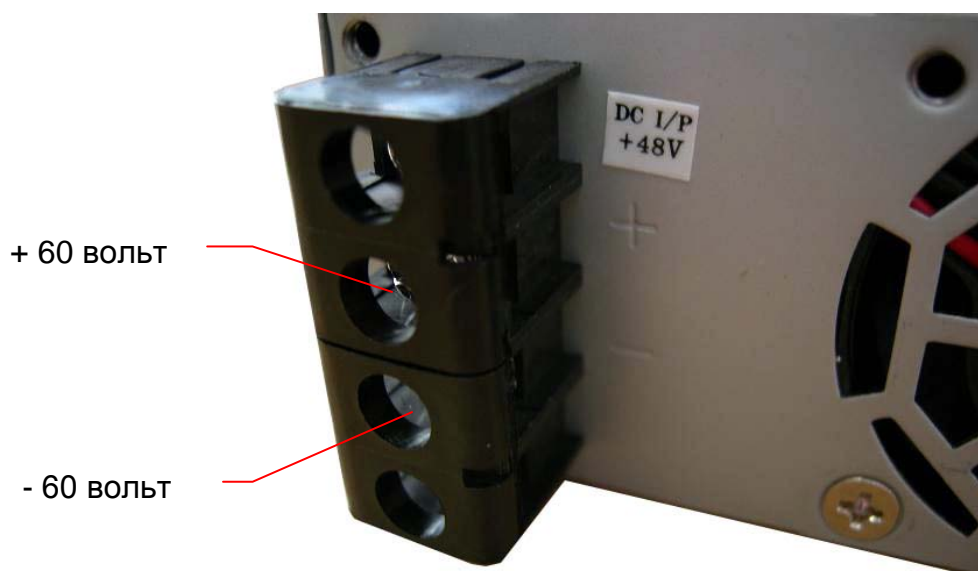
Рис. 2.4. Внешний вид разъема питания и назначение контактов
