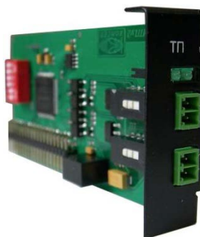
Рис. 2.18. Внешний вид модуля «Токовая петля»
