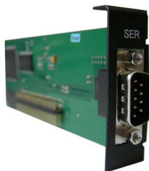
Рис. 2.15. Внешний вид модуля «SER»
