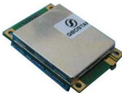
Рис. 2.21. Внешний вид модуля «ГЛОНАСС/GPS» типа «ГеоС-1»
