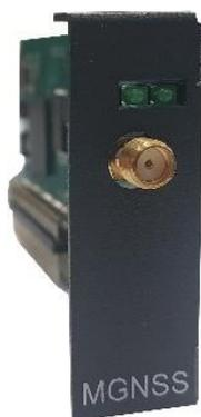
Рис. 2.19. Внешний вид модуля MGNSS
