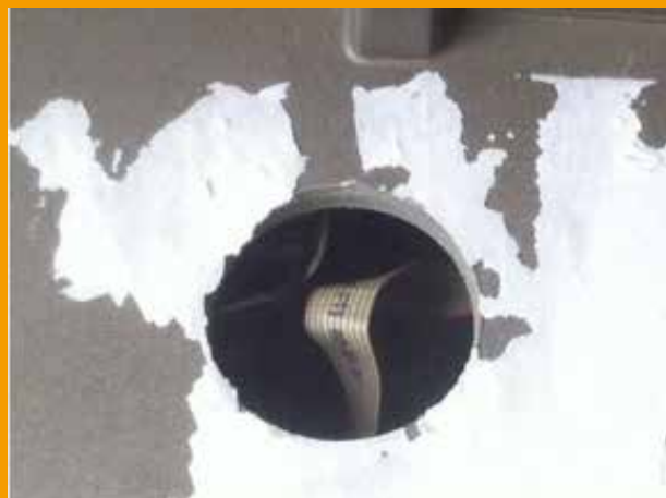
Рис. 1 Сверление отверстия для получения доступа к шине данных между системным блоком и диспенсером. Видны два ряда ровных отверстий, для получения доступа к шине данных RS 485.
